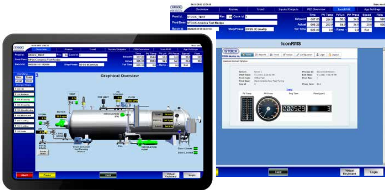
▲ (蒸馏机、相关气压及循环泵状态监控)
